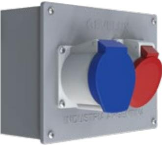
Las cajas TCE se utilizan para realizar **conexiones eléctricas en áreas con alto grado de humedad o a la intemperie**. Su utilización permite la alimentación de energía a artefactos eléctricos portátiles, donde el suministro temporario de energía es indispensable y donde deba efectuarse en forma rápida el corte de corriente eléctrica. Incluye dos tomacorriente que pueden ser de 16 y/o 32A
